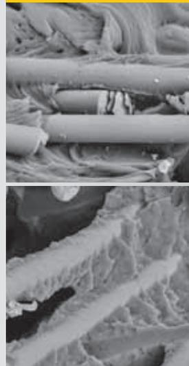
Besonders bei glasfaserverstärktem Polyamid verbessert die Bestrahlung das mechanische Verhalten erheblich. Schon bei Raumtemperatur haften Glasfaser und Polymermatrix besser an und verleihen dem Material eine deutlich höhere Festigkeit. Der Grund: die übergreifende Vernetzung an den Grenzflächen zwischen Glasfaser-Schlichte und Kunststoffmatrix.
