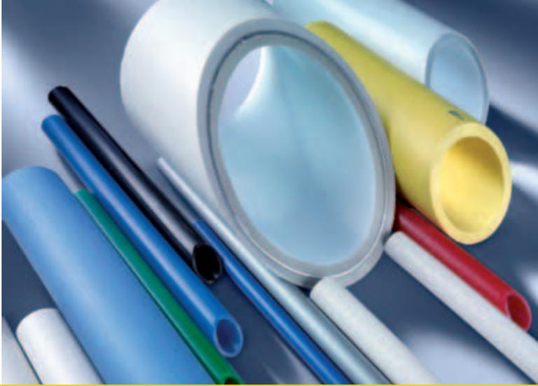
*Gängigstes Material für die Herstellung von Schläuchen ist PE. Dagegen werden medienführende Schläuche oder Rohre, die höchste Anforderungen an Temperaturbeständigkeit und Berstdruckfestigkeit erfüllen müssen, aus strahlenvernetztem PA-11 hergestellt.*
