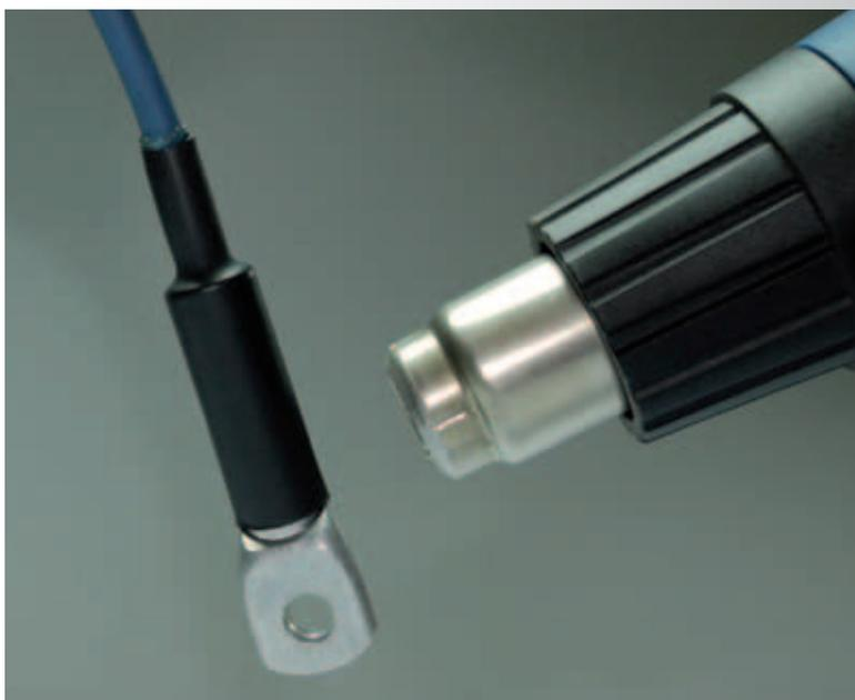
*Die bei der Strahlenvernetzung erzeugten Vernetzungsstellen sind für die Rückstellkräfte verantwortlich, die unter Erwärmung einsetzen.*
